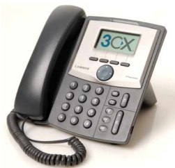
Figura 2 - Un teléfono SIP basado en hardware
