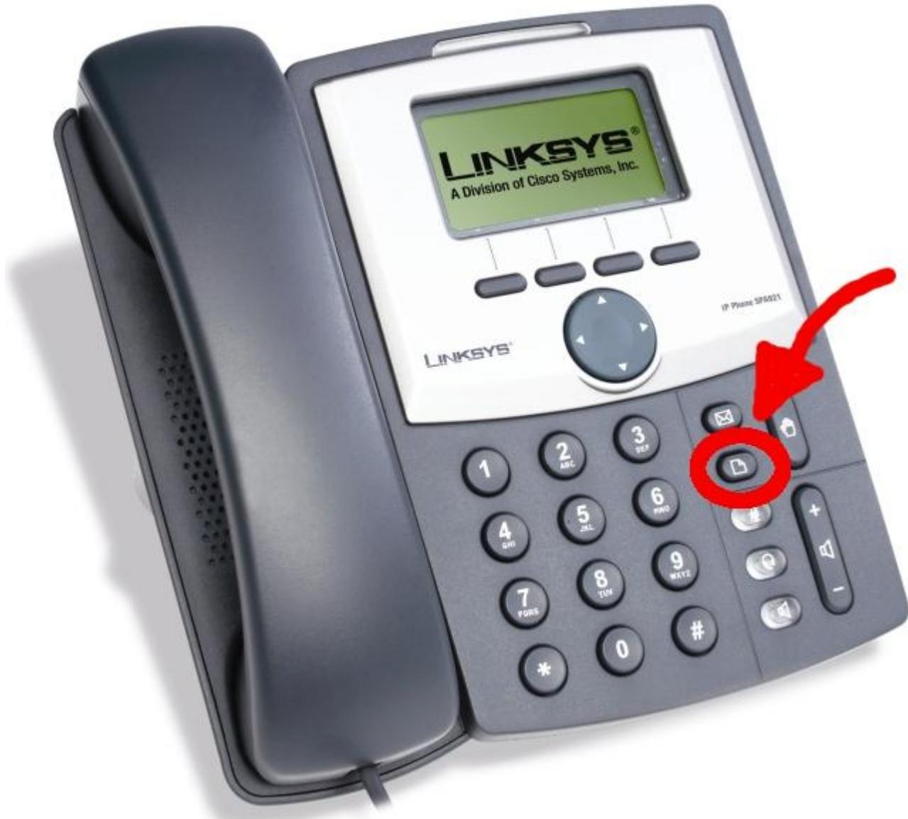
El menú de configuración que aparece en la pantalla del SPA puede navegarse con el teclado redondeado que tienen 4 flechas de dirección o seleccionando el número del apartado a configurar. La dirección IP está en el menú número 9 por lo que puede acceder apretando el botón de setup y a continuación bajar 9 veces o pulsando sobre la tecla del número 9 del teclado numérico de su SPA. Por defecto el idioma del terminal es inglés por lo que aparecerá la IP en el parámetro **Current IP**.
