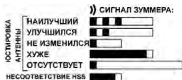
Рисунок 3-12: Последовательность звуковой сигнализации при юстировке антенны
