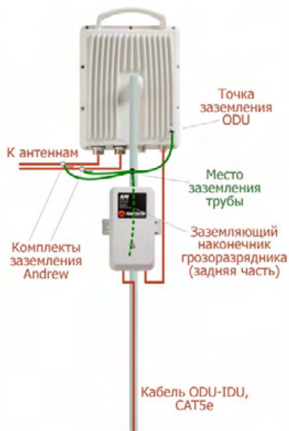
Рисунок С-4: Грозоразрядник и заземление ODU
