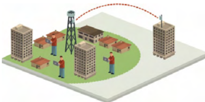
Рисунок 1-3: Типовое применение для организации транспортных каналов на WiFi-технологиях
