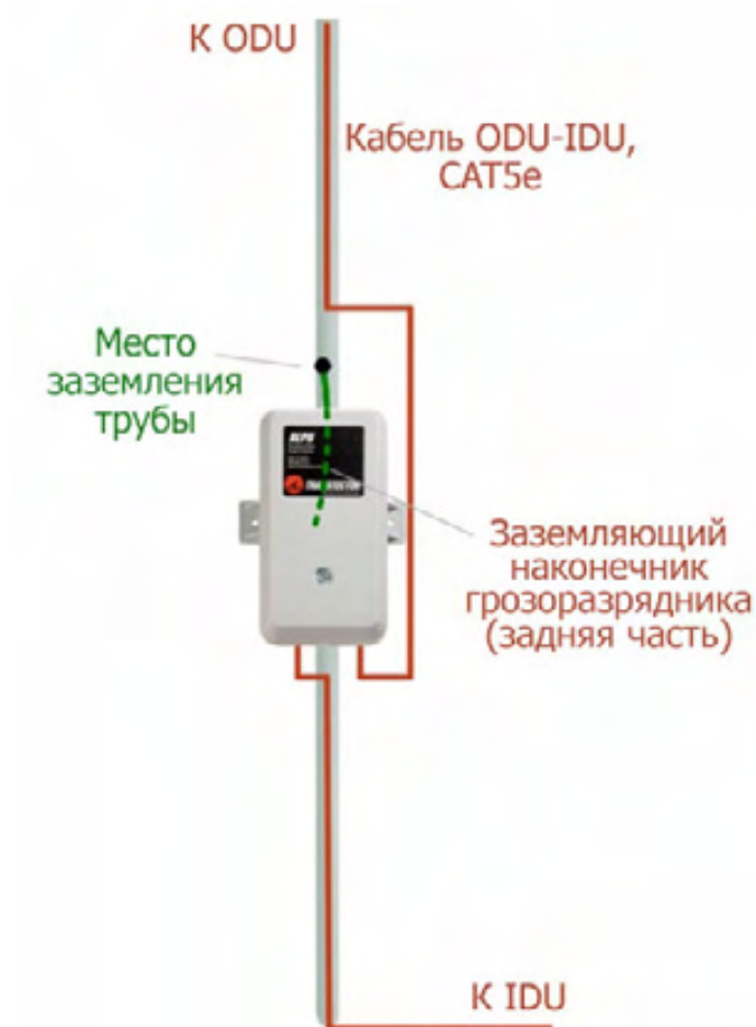
Рисунок С-6: Грозоразрядник и заземление у точки входа кабеля в здание
