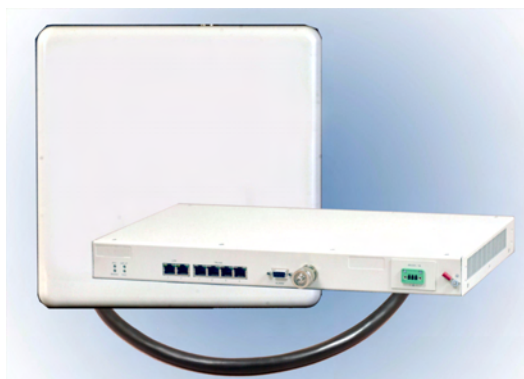
Рисунок 1-9: Блок AIND - "Полностью внутренний" подключен к антенне
