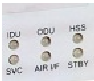
Рисунок 3-15: Индикаторы на передней панели IDU-C
