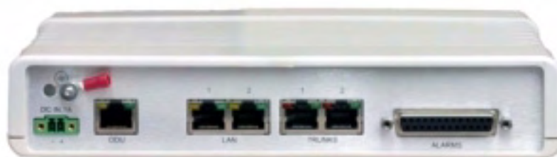
Рисунок 1-13: Задняя панель IDU-R
