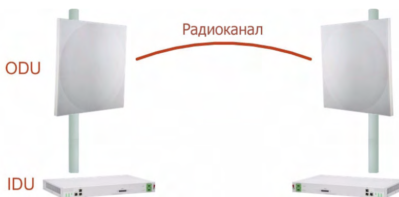
Рисунок 1-7: Пример архитектуры канала связи - компоненты системы
