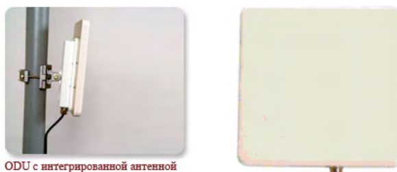
Рисунок 1-22: ODU с интегрированной антенной (виды сбоку и спереди)
