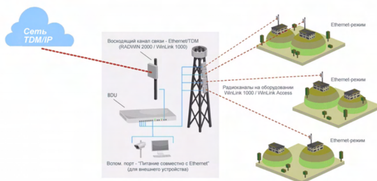
Рисунок 1-21: Типовое применение схемы "многоточка-точка" с беспроводным восходящим каналом связи
