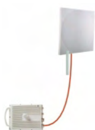
Рисунок А-7: Неправильно смонтированный ODU (без "провисания")
