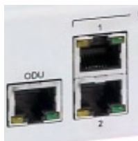
Рисунок 4-1: LAN-порты на передней панели IDU-C
