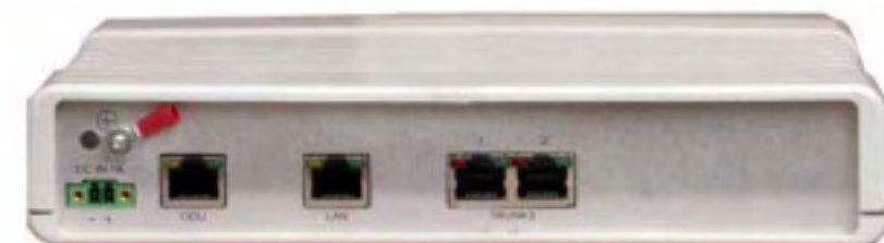
Рисунок 1-11: Типовая задняя панель IDU-E
