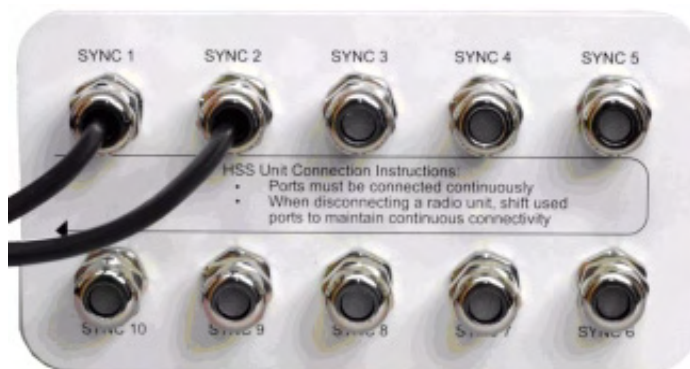
Рисунок Н-4: Соединительный модуль HSS
