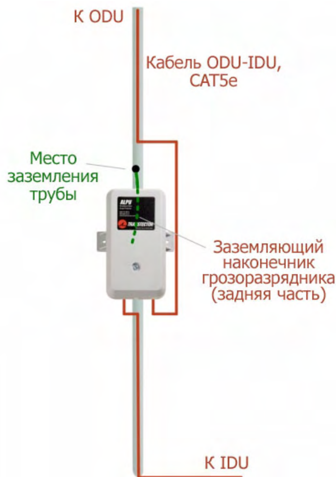
Рисунок С-6: Грозоразрядник и заземление у точки входа кабеля в здание
