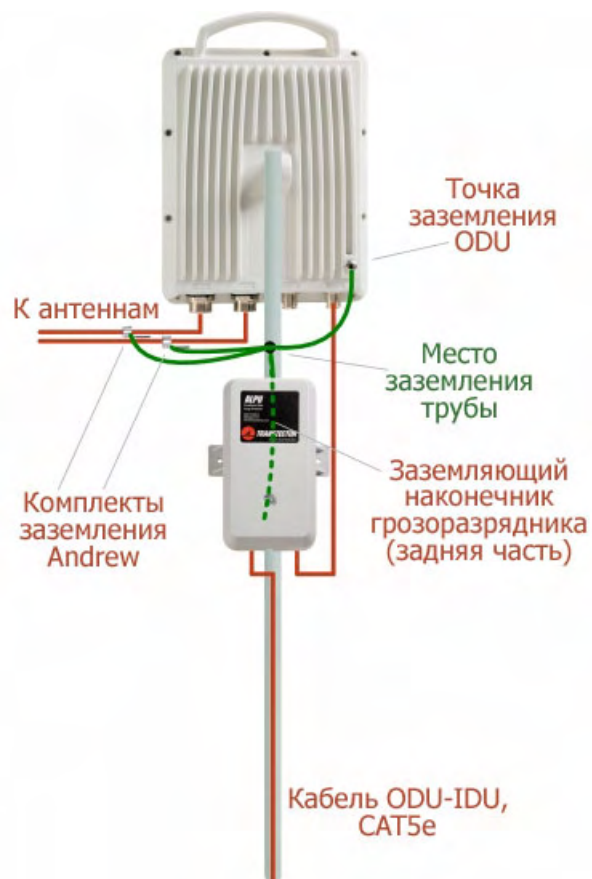
Рисунок С-4: Грозоразрядник и заземление ODU
