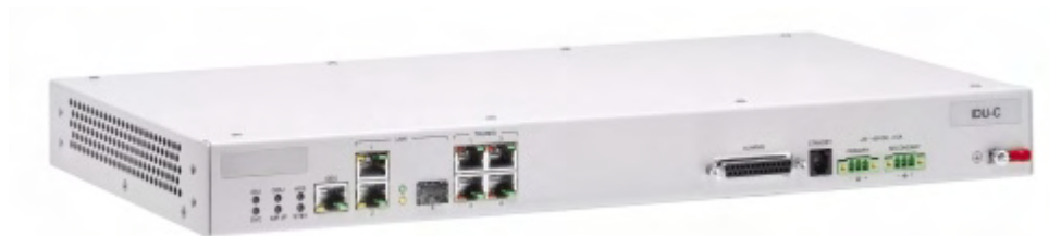
Рисунок 3-6: Содержимое комплекта IDU-C - блок IDU-C, 4 порта E1/T1 1
