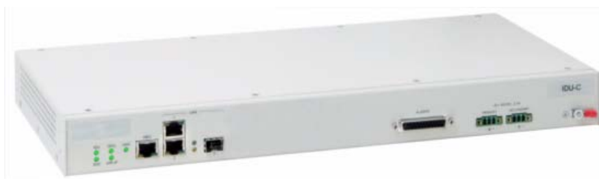
Figura 1-14: IDU-C, sólo Ethernet, panel frontal
