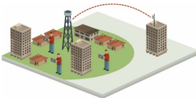
Figura 1-3: Típica aplicación de backhaul WiFi
