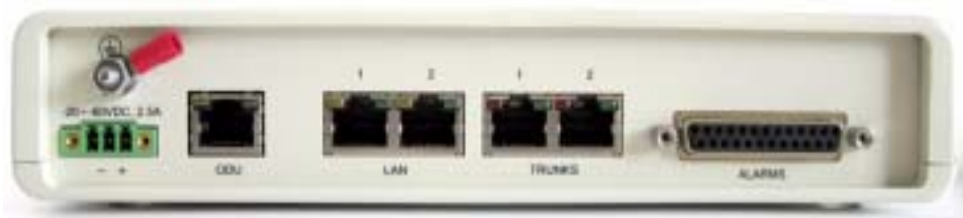
Figura 1-11: Nueva unidad IDU-E: Panel posterior
