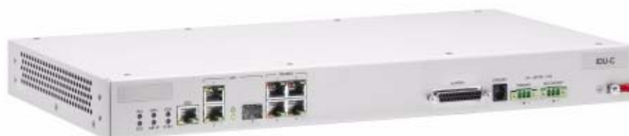
Figura 3-6: Contenidos del paquete IDU-C de la IDU modelo C, 4 puertos E1/T1 1
