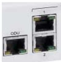
Figura 4-1: Puertos de LAN en el panel frontal de la IDU-C
