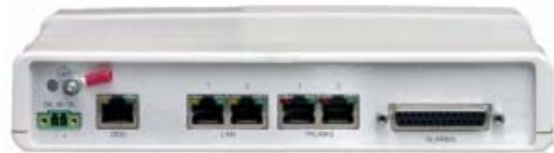
Figura 1-12: Panel posterior de la unidad IDU-R
