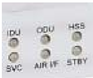
Figura 3-15: LEDs del panel frontal de IDU-C
