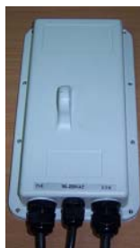
Figura 1-18: Dispositivo O-PoE: La entrada es la alimentación de CA principal
