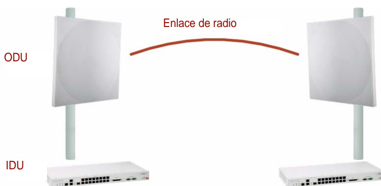
Figura 1-7: Ejemplo de arquitectura del enlace - Componentes del sistema
