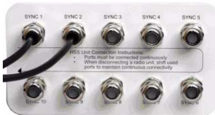
Figura 10-4: Unidad de interconexión HSS
