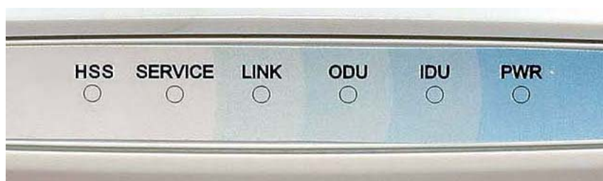
Figura 3-16: LEDs del panel frontal de unidad IDU-E
